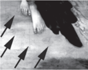
fig.7 赤外線ビジコンカメラ映像（部分撮影） 矢印のところに方眼の線が見える
