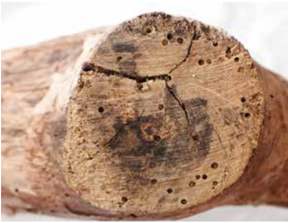
カラー図 24、25 木材パーツに見える虫の脱出孔の例（左：木材パーツ①、右：木材パーツ⑧）
