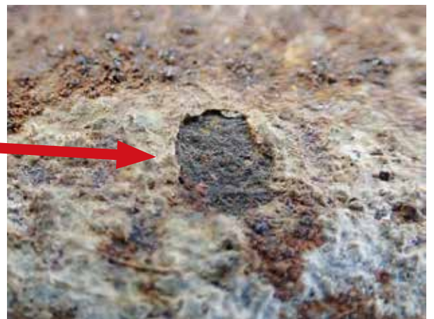
カラー図 22、23 腐食が進行し、表面の金属がうろこ状にはがれてしまった箇所（鋼管G）
