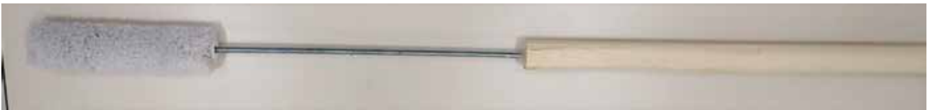
カラー図 38 手製の柄に錆止め塗料用ブラシを取り付けたもの
