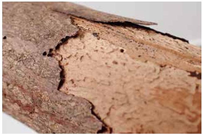
カラー図 26、27 樹皮と木部との間に虫の食害を受けた例（左右の写真ともに木材パーツ③）
