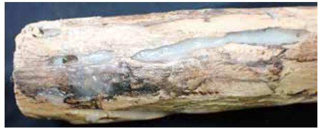
カラー図 33 予備パーツに見られるボンドによる補強例
