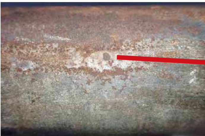
カラー図 22、23 腐食が進行し、表面の金属がうろこ状にはがれてしまった箇所（鋼管G）
