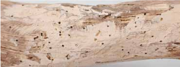
カラー図 34 充填部分にみられる虫の脱出孔の例 (木材パーツ③)
