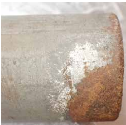
カラー図 20、21 2種類の腐食の例（左：鋼管B、右：鋼管D）
