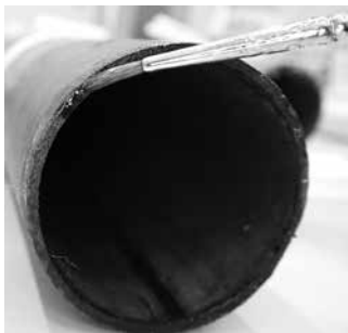
図9 鋼管木口部分への合成樹脂溶液の塗布
