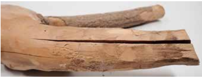
カラー図 32 木材パーツの比較的大きい割れの例 (木材パーツ③)
