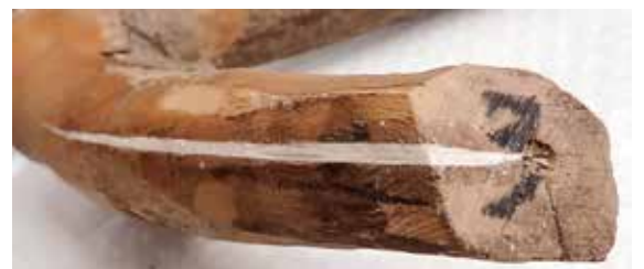
カラー図 40 部材接着後余分なところを切り取り、木材パーツ表面の形に合わせて整形
