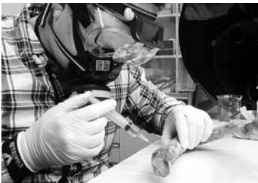
図10 木材パーツへの合成樹脂の注入
