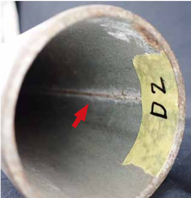
カラー図3 鋼管の継目の例（鋼管D）
