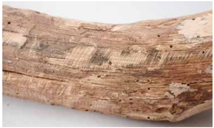
カラー図 24、25 木材パーツに見える虫の脱出孔の例（左：木材パーツ①、右：木材パーツ⑧）
