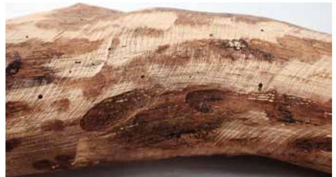
カラー図 14 樹皮を削り落としたような道具跡の例 (木材パーツ②)
