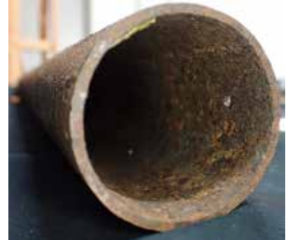
カラー図 35 腐食により粗い表面構造となった鋼管内部の例 (鋼管G)
