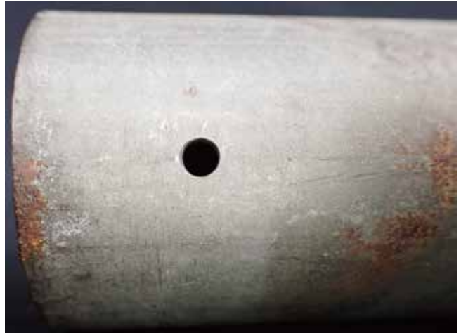
カラー図4 鋼管の端にあけられた穴の例（鋼管A）
