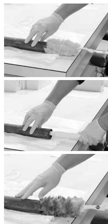
図 4-6 鋼管内部のドライクリーニング
