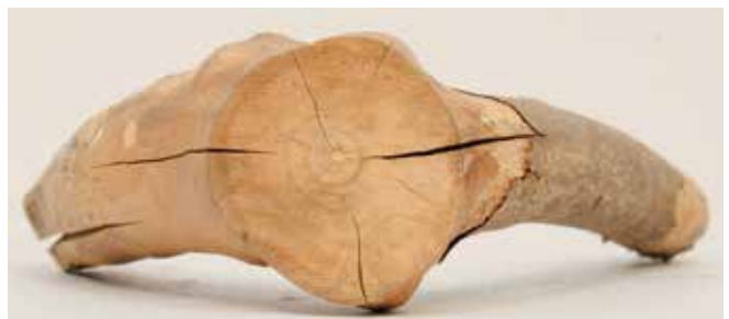
カラー図 31 木材パーツの割れの例（木材パーツ③）
