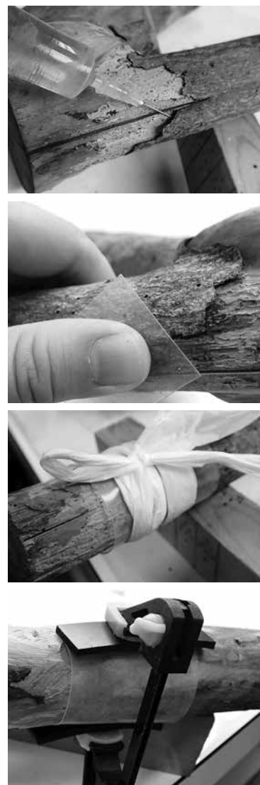
図12-15 樹皮の木部への接着と3種類の圧着方法
