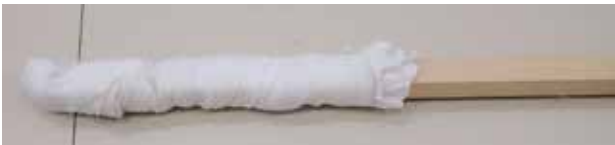
カラー図 36 鋼管内部に合成樹脂溶液を塗布するための手製の道具 (角材にウエスを巻き付けたもの)
