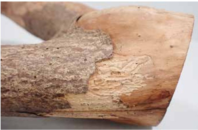
カラー図 26、27 樹皮と木部との間に虫の食害を受けた例（左右の写真ともに木材パーツ③）
