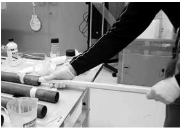
図7、8 鋼管内部への合成樹脂溶液の塗布の様子
