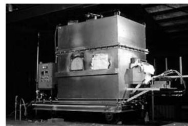
図7 自ら設計した「Glass」シリーズ制作のための溶解炉
